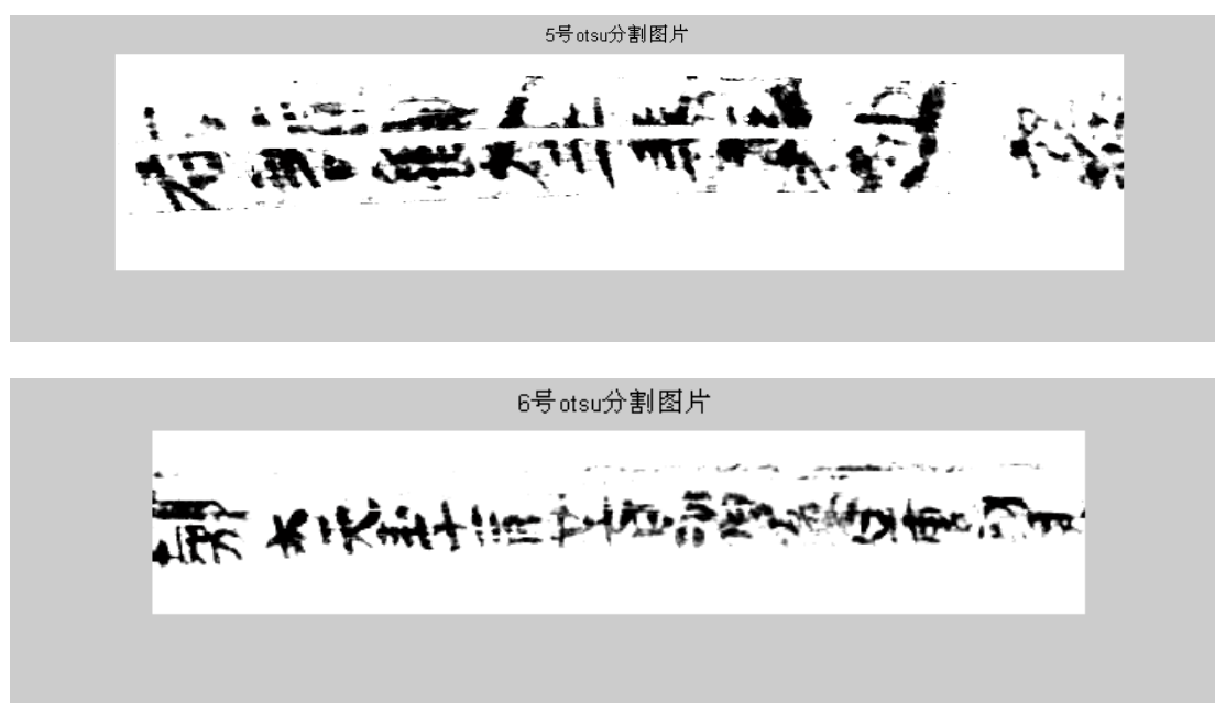
图 5-7 5-6 号普通 Otsu 算法分割图
